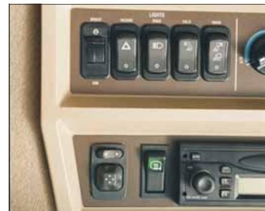
**Верхняя панель управления** дает возможность включать/выключать освещение, контролировать температуру, оперировать радио, включать/выключать аварийное освещение.
