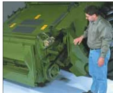
**Навесной защитный боковой щиток наклонной камеры** обеспечивает беспрепятственный доступ к редуктору реверса, приводному валу и фиксатору жатки.
