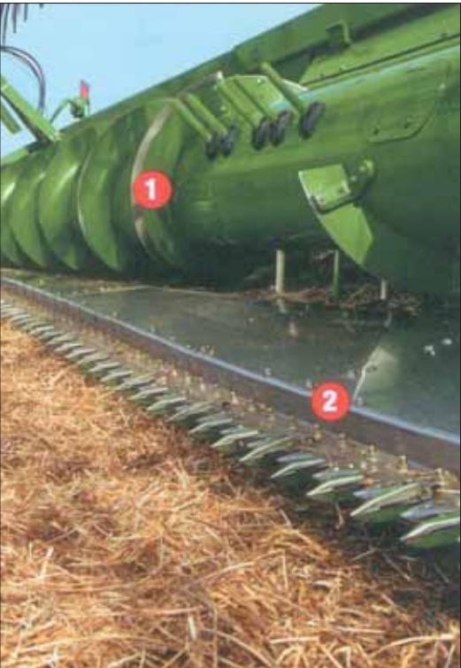
**① Шнек диаметром 66 мм** вместе с 12,7 сантиметровыми витками дают возможность подачи большего количества хлебной массы. К тому же, длинные втягивающиеся пальцы, размещенные по всей длине шнека, обеспечивают равномерную подачу массы к наклонной камере.
