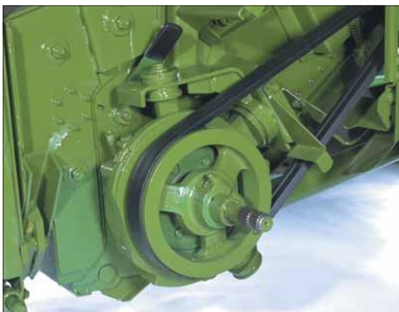
Механический реверс мощностью 80 л.с. приводится в действие непосредственно от двигателя. Отныне Вам не придется спускаться из кабины для удаления забитой массы. Вы сможете легко удалить накопившуюся массу простым нажатием кнопки. Это позволяет снизить простой техники, тем самым увеличивается производительность работы.
