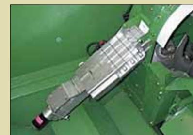
Датчик влажности вмонтирован в зерновой бункер, что является стандартным оборудованием на комбайнах серии 9000*i* STS.
