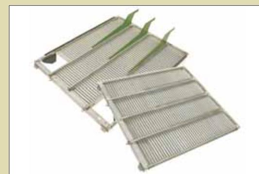
**Прямые цельные решета верхней и нижней очистки.** Такая конструкция упрощает демонтаж для очистки решет. Глубокие жалюзи верхнего и нижнего решет (стандартное оборудование для уборки кукурузы) предотвращают потери на уклонах.
