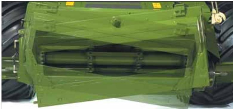
Для копирования профиля почвы передняя подвижная рама наклонной камеры наклоняется вверх/вниз под углом 9 градусов и под углом 4 градуса вправо/влево. Это обеспечивает поддержание одинаковой высоты среза материала и снижает возможность захвата почвы даже на неровных полях.
