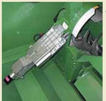
Датчик влажности вмонтирован в зерновой бункер. Он постоянно замеряет температуру и содержание влаги в зерне. Кроме того, точность системы позволяет произвести пересчет и получить величину урожайности в тоннах сухого зерна. Боковая крышка легко снимается, что дает возможность оператору производить очистку датчика, стоя на земле.
