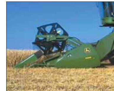
**Благодаря небольшому углу наклона наклонной камеры** срезанный материал направляется равномерной массой к системе обмолота.
