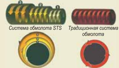
**В отличии от традиционной роторной конструкции в комбайнах John Deere STS ротор вмонтирован эксцентрически по отношению к кожуху ротора. Кроме того, диаметр кожуха увеличивается при переходе из зоны подачи массы в зону обмолота и из зоны обмолота в зону сепарации. Такая технология требует существенно меньших затрат энергии и гарантирует лучшее качество зерна и соломы.**
