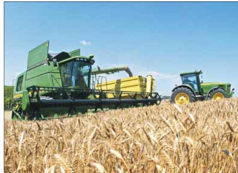
При работе на склонах на обычном комбайне корпус машины наклоняется, вследствие чего центр тяжести машины смешается. При этом смешается и зерно в комбайне. Это снижает фактический объём зернового бункера почти на 25%. Система выравнивания HILLMASTER II удерживает корпус машины в горизонтальном положении, позволяя использовать весь объём зернового бункера. Это гарантирует высокую производительность работы и удобство оператора.
