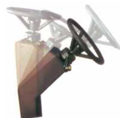
**Регулированная рулевая колонка** (стандартное оборудование) легко регулируется под Ваш рост. Необходимо лишь нажать педаль установленную в нижней части рулевой колонки и она плавно меняет угол наклона до 42 градусов.
