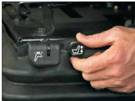
**Удобное и эргономичное сидение** регулируется в четырех положениях и может быть точно "подогнано" под оператора. Регулировка наклона спинки сидения поможет максимально сократить нагрузку на спину при работе.
