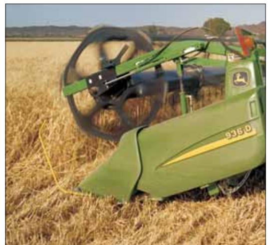
**Высокочувствительные сенсоры** позволяют поддержать запрограммированную высоту среза на неровных полях. Высота среза может регулироваться от 4 см.
