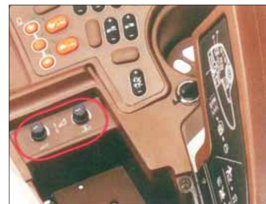
**Ручки системы активного управления жатки.** Ручка справа – отслеживание высоты жатки активного управления плавающим режимом жатки. Ручка слева – ручное управление восстановлением высоты жатки.
