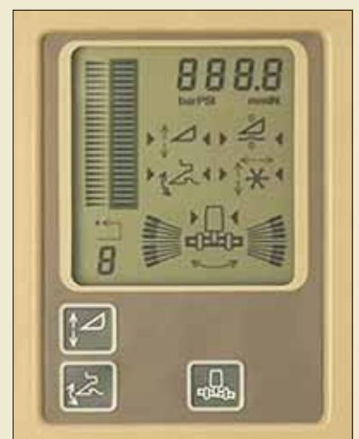
**Используйте возможности системы Contour-Master™** на дисплее активного управления жатки. Дисплей непрерывно выдает информацию об уровне наклона жатки по отношению к поверхности поля и позволяет ее регулировать.
