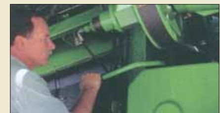
**Двухдиапазонный привод ротора** дает Вам широкий выбор скорости вращения в зависимости от типа культуры. Верхний диапазон обеспечивает от 380 до 1000 об/мин, нижний 210-550 об/мин. Изменение диапазона осуществляется с помощью рычага.
