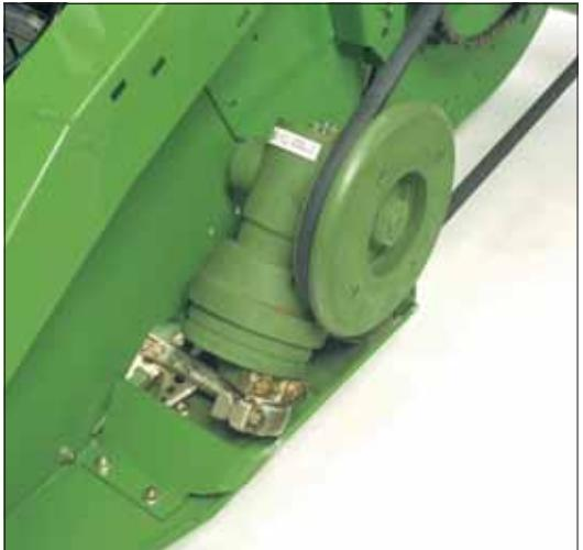
**Надежный планетарный механизм привода ножей** увеличивает производительность и гарантирует надежность. Механизм качающейся шайбы обеспечивает более мягкий привод ножей.
