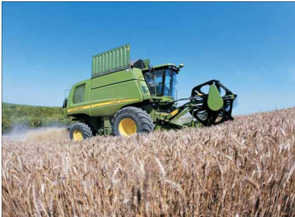
Система HILLMASTER II компенсирует изменение наклона рельефа и автоматически выравнивает комбайн на склонах до 15 градусов, сохраняя при этом идеально ровное положение комбайна. Передняя рама наклонной камеры также подвижна, что позволяет жатке полностью копировать рельеф поля. Как работает эта система? В боковые рамы комбайна встроены два сверхмощных цилиндра. Эти цилиндры могут поднимать и опускать конечные передачи и колёса, сохранив тем самым
