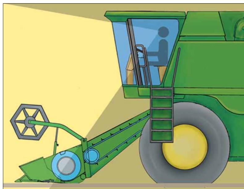
**Отличный обзор.** На комбайнах этой серии наклонная камера несколько опущена и выдвинута вперед, это обеспечивает непревзойденный обзор жатки при работе. При этом оператору не приходится приставать с рабочего места или наклоняться вперед.
