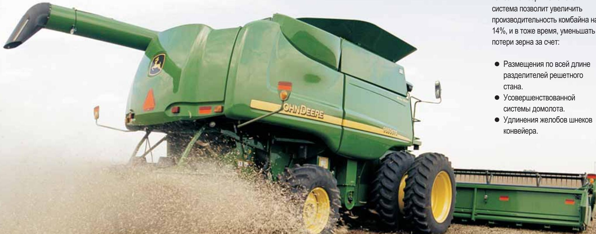
Если Вы работаете на уклонах и холмистой местности, то Вам будет кстати возможность установки системы SideHill (опция) на всех комбайнах серии STS. Эта система позволит увеличить производительность комбайна на 14%, и в тоже время, уменьшать потери зерна за счет:
