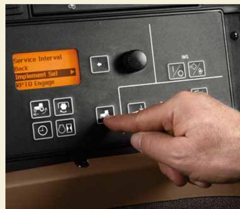
Панель управления CommandCenter является основной информационной системой тракторов Джон Дир серии 7030. Данная панель управления позволяет оператору запрограммировать различные параметры и задать показатели для определенных видов работ. Панель управления CommandCenter позволяет получить различную информацию буквально с помощью кончиков пальцев.
