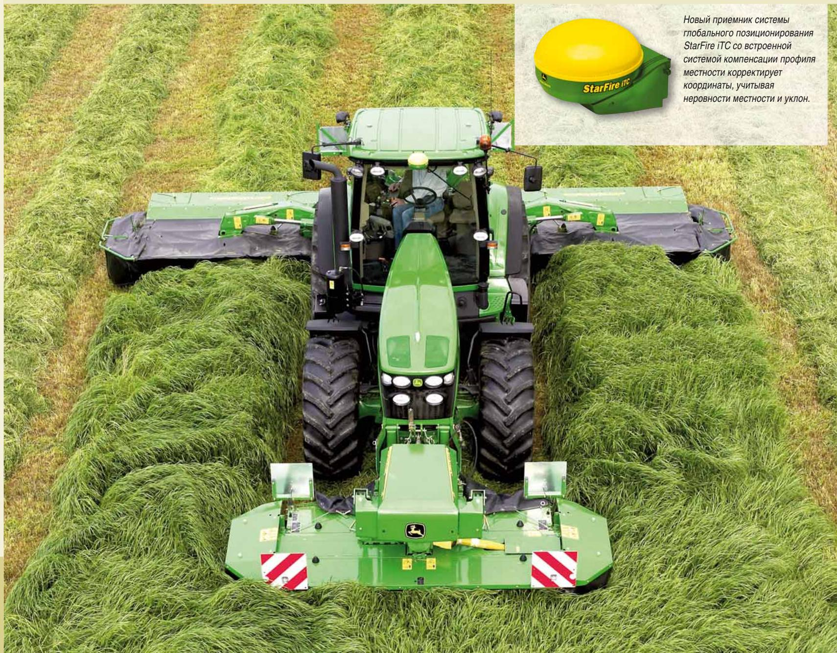
Новый приемник системы глобального позиционирования StarFire iTC со встроенной системой компенсации профиля местности корректирует координаты, учитывая неровности местности и уклон.
