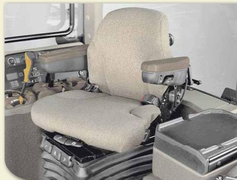
Удобное пневматическое сиденье со съемной подушкой для удобства чистки, включает в себя широкие подушки для удобства оператора, поясничный упор, ремень безопасности, пневмоподвеску, датчик присутствия оператора в сиденье, регулируемую спинку.
