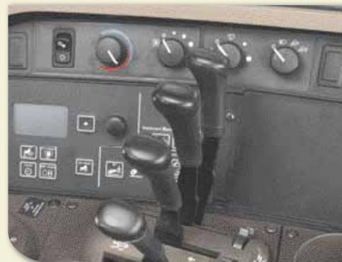
Управление кондиционером, частотой вращения вентилятора, температурой воздуха, режима антизапотевания и антизамерзания стекла осуществляется на правосторонней консоли над панелью управления CommandCenter для легкого использования во время управления трактором. Трехпозиционный выключатель позволяет выбрать режимы кондиционирования воздуха, антизамерзания или обогрева.
