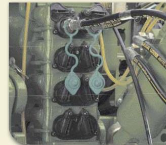
На тракторах серии 7030 2, 3, или 4 гидрорычаги оснащены панелью управления расположенной на консоли. Все задние гидрорычаги оборудованы разрывными муфтами, регулировкой скорости потока и временем.
